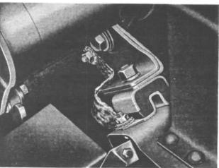
FIG. 10-ENGINE GROUND STRAP
