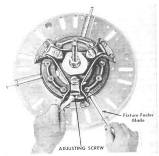
FIG. 177—ADJUSTING LEVERS ON AUBURN CLUTCH
