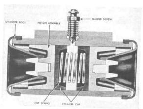
FIG. 286—WHEEL BRAKE CYLINDER
