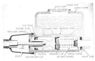
FIG. 285-BRAKE MASTER CYLINDER
