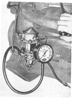
FIG. 139—FUEL PUMP PRESSURE TEST
