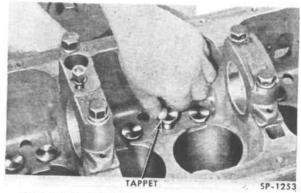
FIG. 30—REMOVING VALVE TAPPET FROM CYLINDER BLOCK
