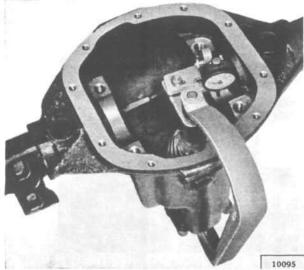
FIG. 256-PINION SETTING GAUGE
