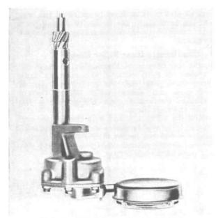
FIG. 73-OIL PUMP AND SCREEN
