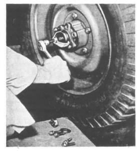
FIG. 228-AXLE SHAFT DRIVE FLANGE PULLER
