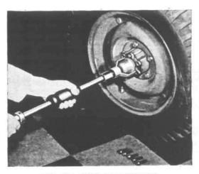
FIG. 227-HUB CAP PULLER
