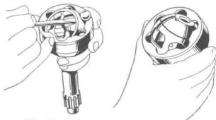
FIG. 230—DISMANTLING RZEPPA JOINT
