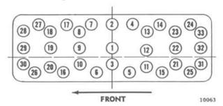
FIG. 92—CYLINDER HEAD BOLT TIGHTENING SEQUENCE
