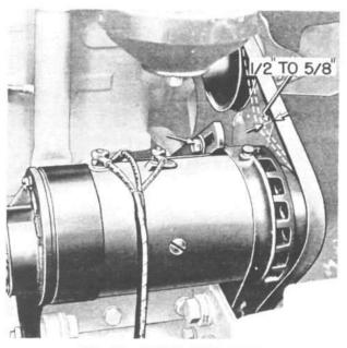
FIG. 154—GENERATOR BRACE
