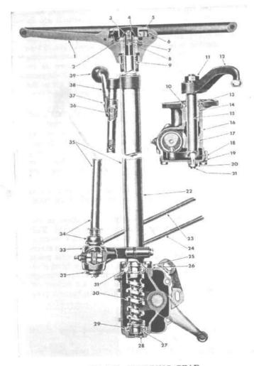
FIG. 278-STEERING GEAR
