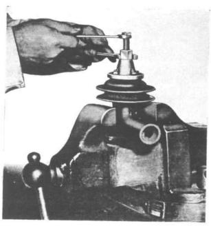
FIG. 151-WATER PUMP FAN HUB PULLER
