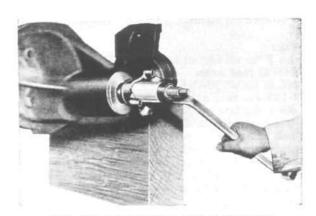
FIG. 258—UNIVERSAL JOINT FLANGE INSTALLING TOOL
