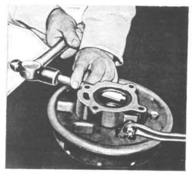
FIG. 217—SPEEDOMETER PINION BUSHING DRIVER
