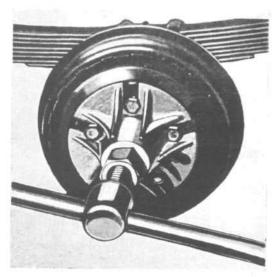
FIG. 240-WHEEL HUB PULLER
