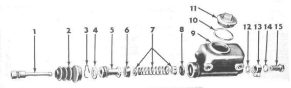
FIG. 284-MASTER BRAKE CYLINDER
