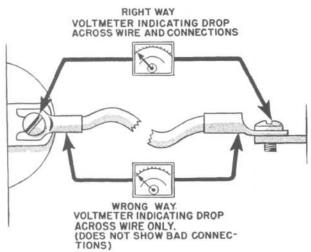
FIG. 17-VOLTAGE DROP TEST
