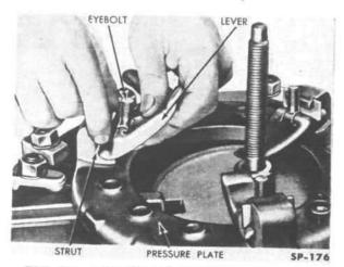
FIG. 184—ASSEMBLING LEVERS ON CLUTCH PRESSURE PLATE
