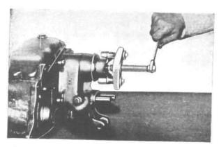
FIG. 208—UNIVERSAL JOINT FLANGE PULLER
