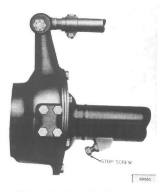
FIG. 239—TURNING ANGLE STOP SCREW
