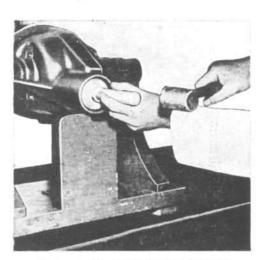
FIG. 254—PINION SHAFT FRONT BEARING CUP DRIVER
