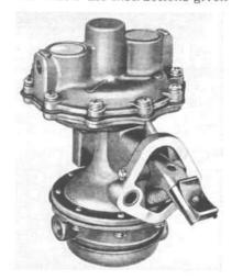
FIG. 141—FUEL AND VACUUM PUMP— L6-226 MODELS
