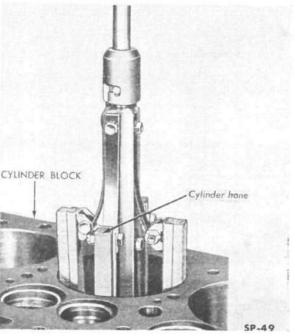
FIG. 35-HONING CYLINDER BORE
