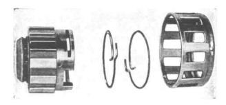
FIG. 200--FREEWHEELING CAM RETAINER
