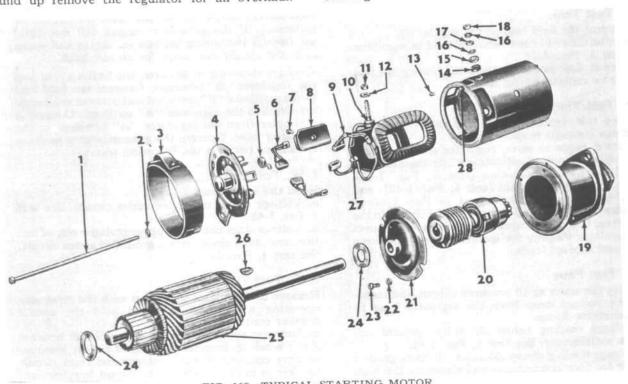
FIG. 169-TYPICAL STARTING MOTOR
