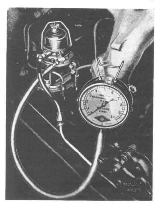
FIG. 15-FUEL PUMP PRESSURE
