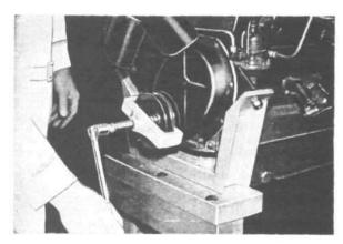
FIG. 105-CRANKSHAFT PULLEY PULLER
