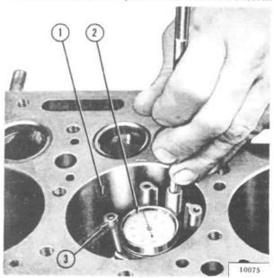
FIG. 34—CHECKING CYLINDER BORE
