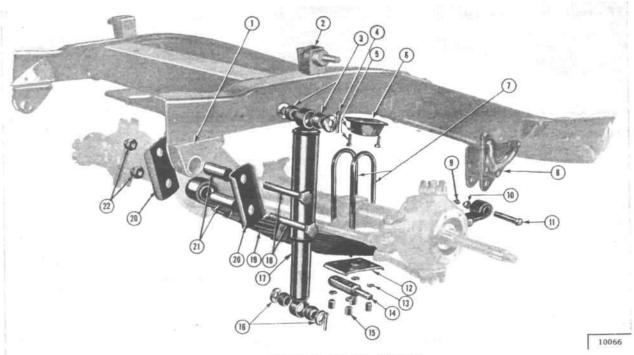
FIG. 301-TYPICAL FRONT SPRING
