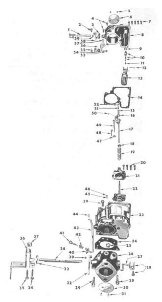
FIG. 133—YF-951S CARBURETOR— F4-134 MODELS
