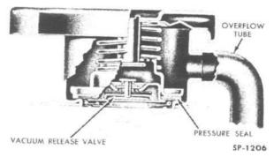
FIG. 147-RADIATOR FILLER CAP
