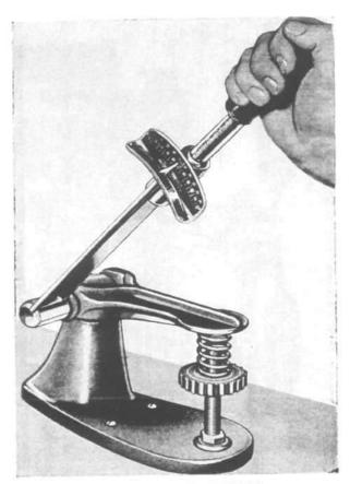
FIG. 99-SPRING TESTING
