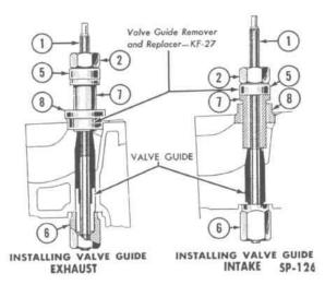
FIG. 67—INSTALLING VALVE GUIDE IN CYLINDER BLOCK
