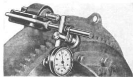
FIG. 125-FLYWHEEL RUNOUT GAUGE
