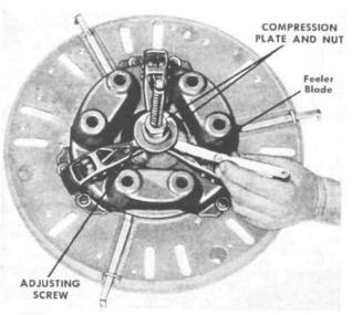
FIG. 179—ADJUSTING LEVERS ON ROCKFORD
