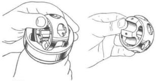
FIG. 231—REMOVING RZEPPA JOINT CAGE
