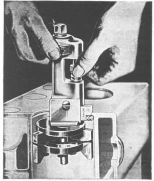
FIG. 114-CYLINDER RIDGE REAMER
