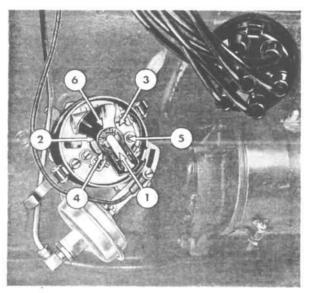
FIG. 164—FIRING POSITIONS—SIX CYLINDER
