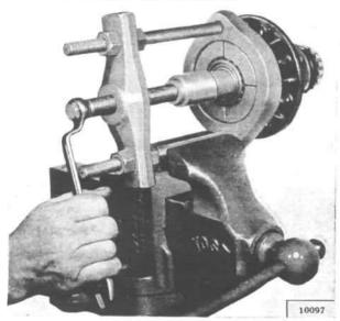
FIG. 241—BEARING PULLER
