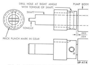
FIG. 78—LOCATING CAMSHAFT GEAR ON OIL PUMP SHAFT
