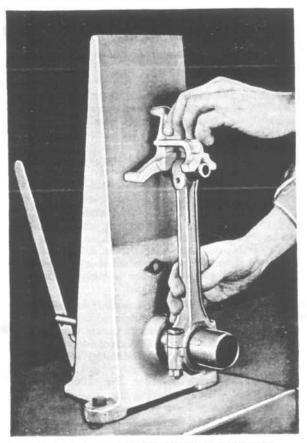
FIG. 111-CONNECTING ROD ALIGNER
