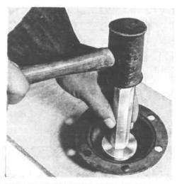
FIG. 277-PINION OIL SEAL INSTALLER
