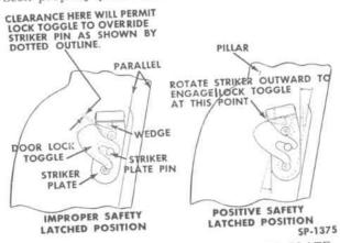
FIG. 304—LOCK TOGGLE AND STRIKER PLATE POSITION
