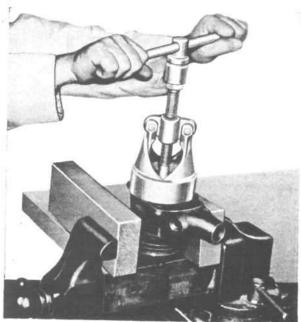
FIG. 150-WATER PUMP IMPELLER PULLER
