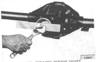
FIG. 250—PULLING PINION SHAFT FRONT BEARING CUP
