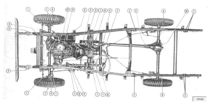
FIG. 7—LUBRICATION CHART — MODEL F4-134 4x4
