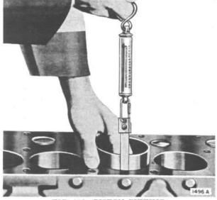
FIG. 113-PISTON FITTING
