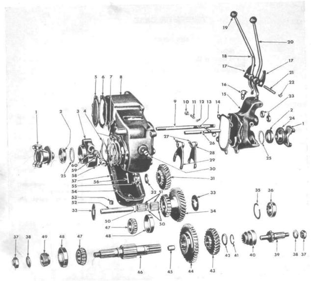
FIG. 207—TRANSFER CASE—4-WHEEL-DRIVE VEHICLES
