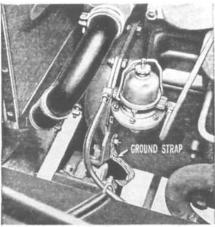
FIG. 126-ENGINE GROUND STRAP
