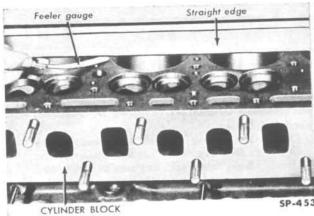
FIG. 33—CHECKING CYLINDER BLOCK FOR DISTORTION
