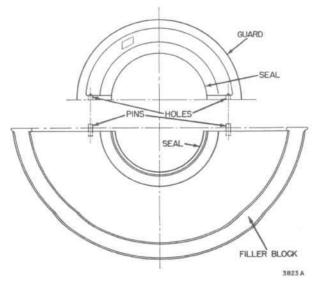
FIG. 70—CRANKSHAFT REAR FILLER BLOCK DOWEL PINS
