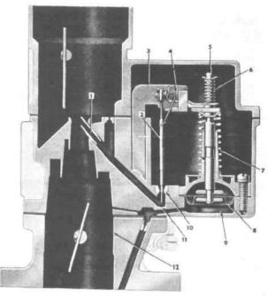
FIG. 130-THE HIGH SPEED CIRCUIT
