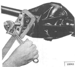
FIG. 248-END YOKE PULLER
