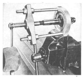
FIG. 251-BEARING PULLER
