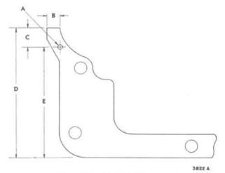
FIG. 91-OIL PAN GASKET HOLE LOCATION
