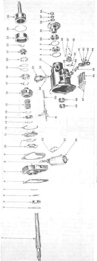
FIG. 199-TRANSMISSION OVERDRIVE-EXPLODED VIEW
