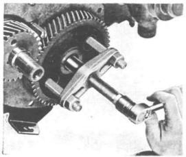
FIG. 106-TIMING GEAR PULLER
