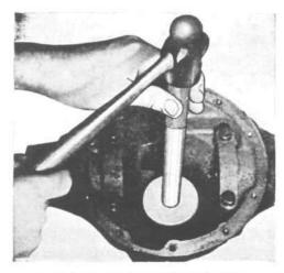
FIG 253—PINION SHAFT REAR BEARING CUP DRIVER
