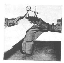
FIG. 266—BACK LASH CHECKING GAUGE
