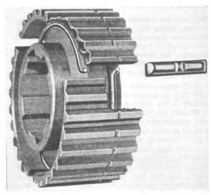
FIG. 193-SYNCHRONIZER SPRINGS
