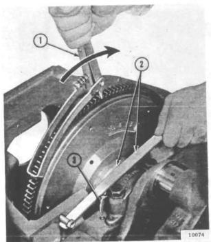
FIG. 27—REMOVING REAR FILLER BLOCK GUARD
