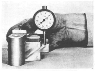
FIG. 257—PINION MASTER GAUGE
