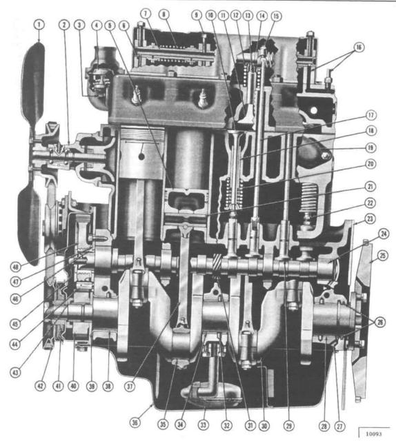
FIG. 98—FOUR-CYLINDER F-HEAD ENGINE—SIDE VIEW
