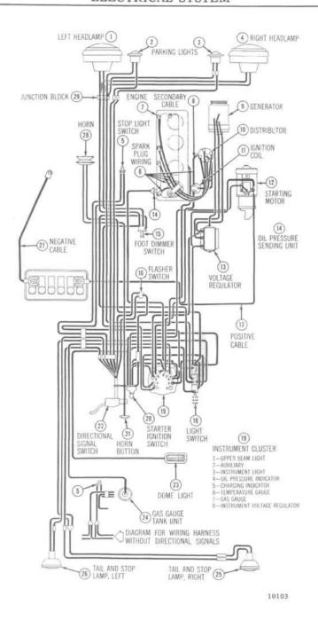
FIG. 157-WIRING DIAGRAM-F4-134 4WD
