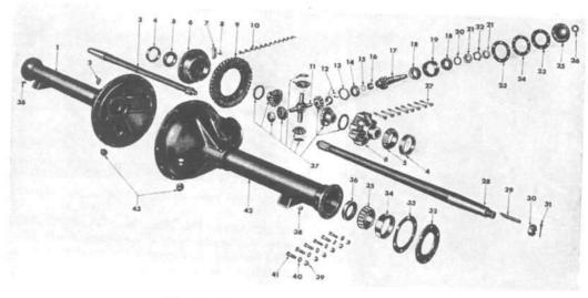
FIG. 270—SPIRAL BEVEL REAR AXLE
