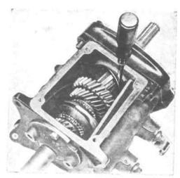
FIG. 203-REAR BEARING SNAP RING
