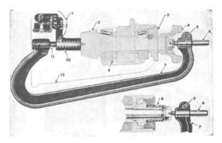
FIG. 255—PINION ADJUSTING FIXTURE
