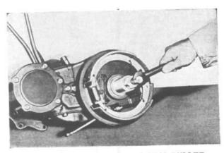
FIG. 211—OUTPUT SHAFT OIL SEAL PULLER
