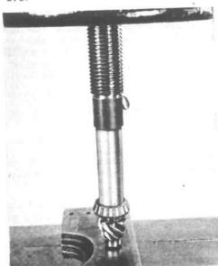
FIG. 275—PINION REAR BEARING INSTALLING SLEEVE
