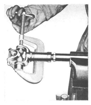
FIG. 225-UNIVERSAL JOINT BEARING CLAMP
