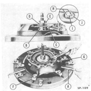
FIG. 185-ADJUSTING PRESSURE PLATE LEVERS
