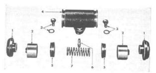
FIG. 287—WHEEL BRAKE CYLINDER
