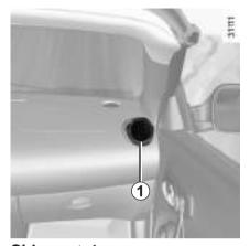
**Side vent 1**To open, press on the air vent.
