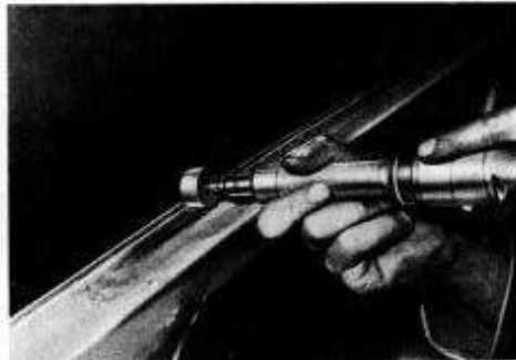
Bild 12. Vorbereiten des neuen Punktrandes
