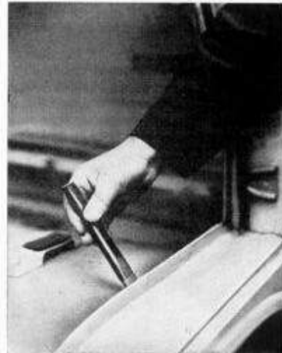
Bild 26. Trennung der Außenhaut vollst. unter der Fahrertür unmittelbar am Punktrand des Radkastens
