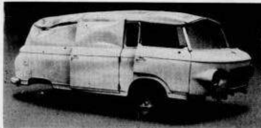
Bild 8. Stark beschädigtes Dach
