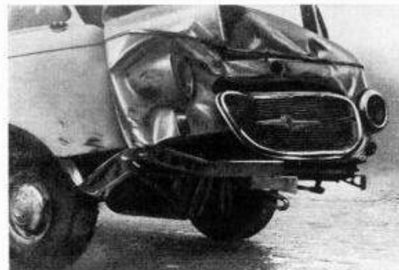
Bild 22. Frontalaufprall des Fahrzeugs „B 1000“ mit stark beschädigter Rahmengabel, Vorderwand vollst. und Boden vorn
