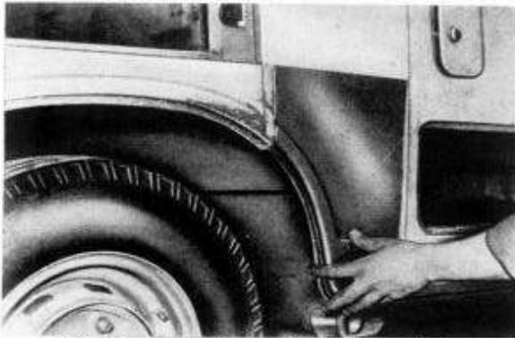
Bild 18. Reparatur am Seitenmittelstück, Außenblech
