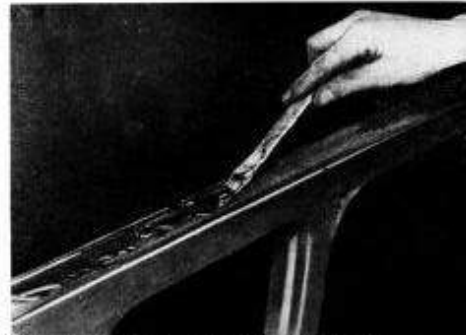
Bild 13. Einstreichen des Punktrandes mit Punktschweißhilfsmitteln
