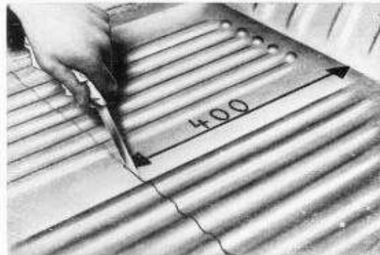
Bild 27. Lage der Trennlinie im Bodenblech
