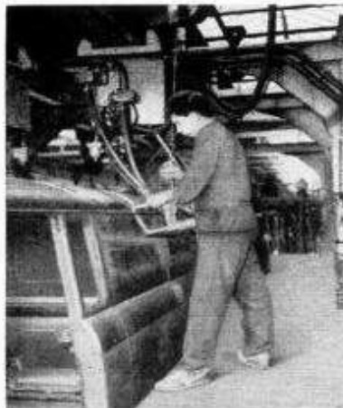
Bild 15. Mit der Handpunktschweißzange wird das Dach mit der Karosserie verpunktet
