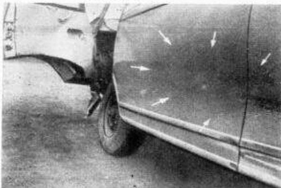
Bild 19. Bei diesem Unfallwagen wurde auch die hintere Außenwand (ganz rechts im Bild) eingedrückt
