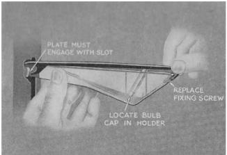
Fig. 58 **Replacing Bulb**
