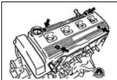
4. Снять покрытие №2 приводного ремня.
