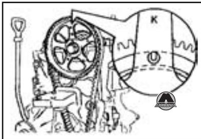
7. Снять шкив коленчатого вала.
