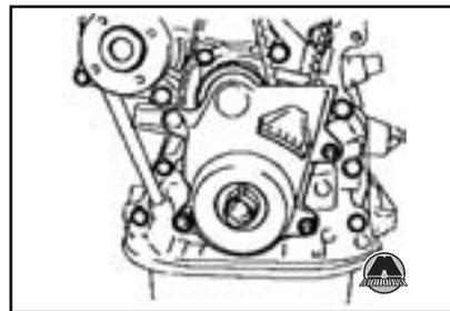
9. Снять направляющую приводного ремня. Издательство "Монолит"
