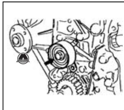
13. Снять монтажное крепление двигателя.
