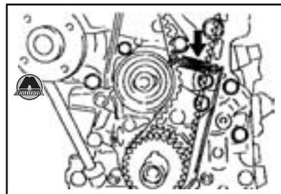
11. Снять приводной ремень.
