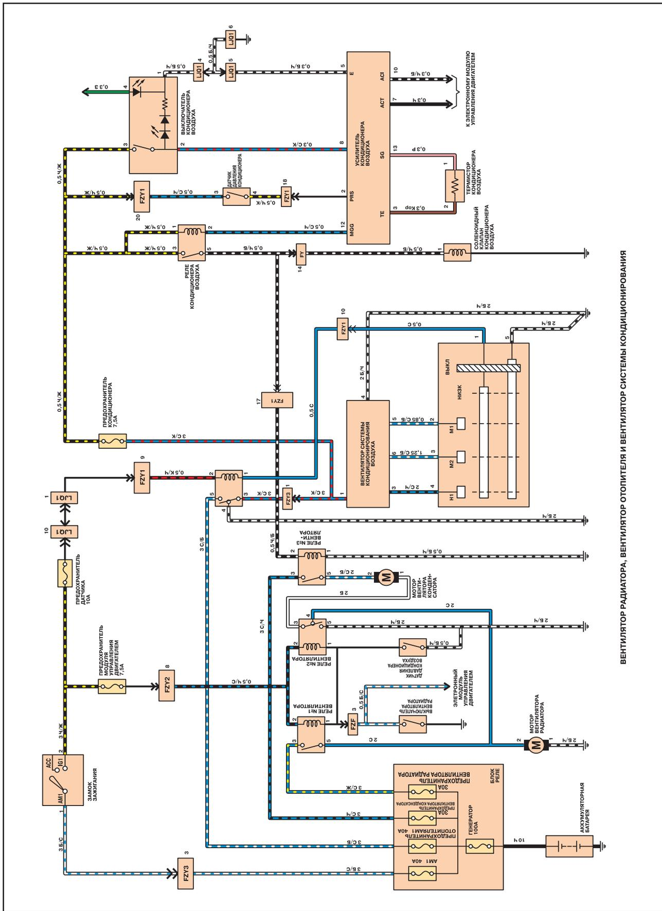
ВЕНТИЛЯТОР РАДИАТОРА, ВЕНТИЛЯТОР ОТОПИТЕЛЯ И ВЕНТИЛЯТОР СИСТЕМЫ КОНДИЦИОНА ВОЗДУХА
