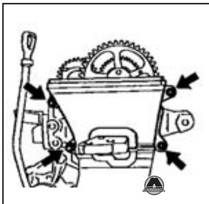
5. Снять шестерню коленчатого вала и покрытие шкива.
