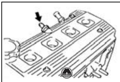
2. Снять вентиляционный клапан.
