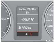
Fig. 51 Gear display
